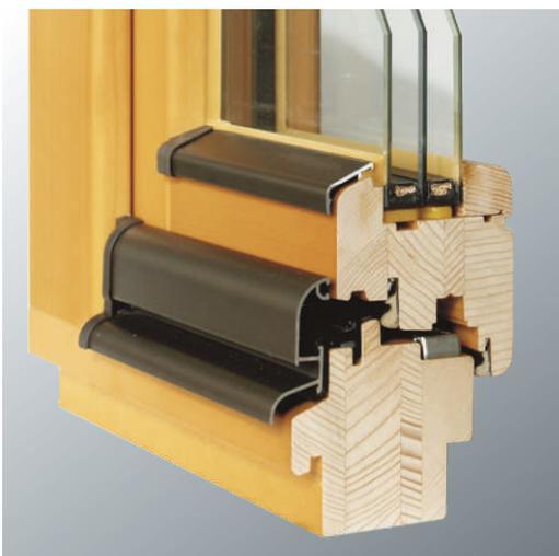
Diese ISARHOLZ-Holzfensterausführung besteht durch elegante und abgerundete Profile für behagliches Wohnen. In Verbindung mit Wärmeschutzgläsern erreicht das Fenster zur Verminderung Ihrer Energiekosten den Wert  $U_w$   $0,8 \text{ W/m}^2 \text{ K}$ .
